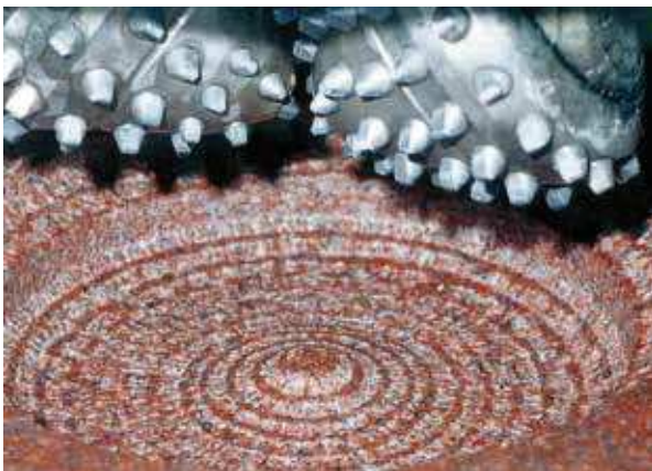
岩盤掘削後の打痕跡
