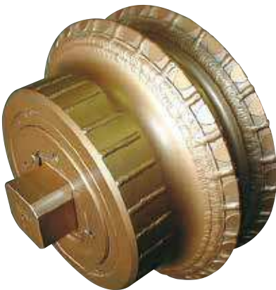
φ360 2山 (ゲージ用) チップインディスクカッター
