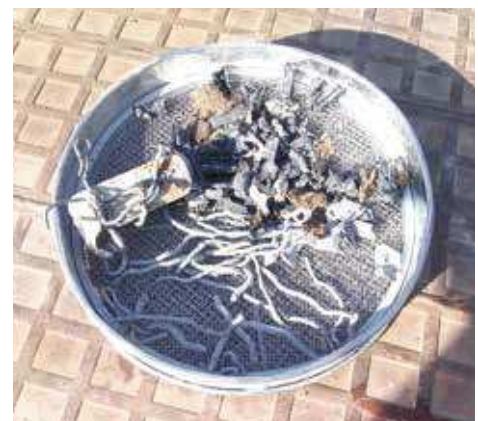
排出された鉄筋、カラー
