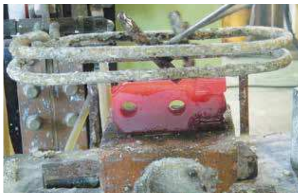
ツースピット 超硬口ウつけ作業
